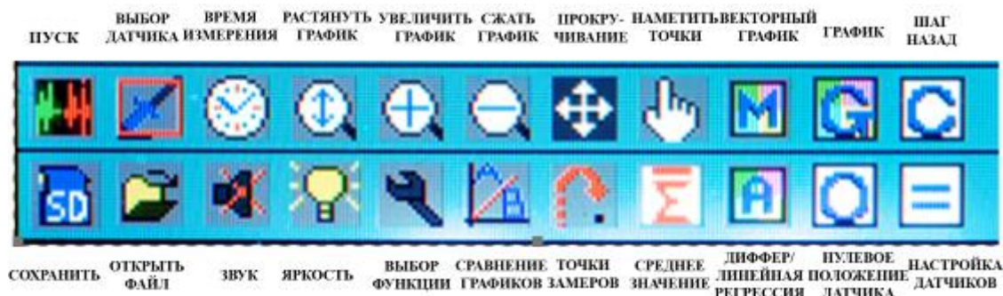
Рисунок 4 – Панель прибора регистрации данных MGA
