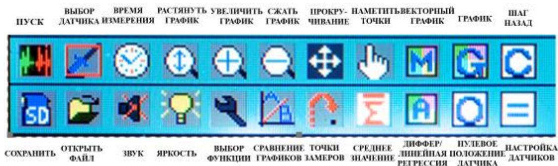
Рисунок 4 – Панель прибора регистрации данных MGA
