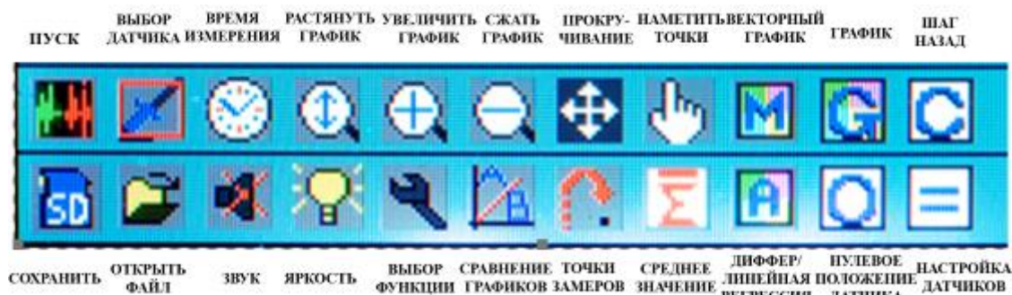
Рисунок 2 – Панель прибора регистрации данных MGA
